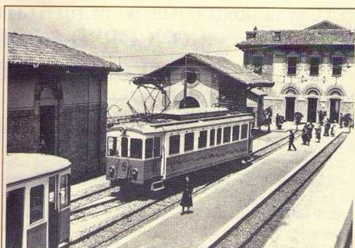
Stazione di San Marino. L'elettromotrice utilizza la "bretella" tra 2° e 3° binario per riportarsi in testa e ricondurre il convoglio a Rimini
